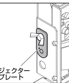
3 レジエクターを固定しているレジエクタープレートの蝶ネジを緩め、レジエクタープレートを外します。
